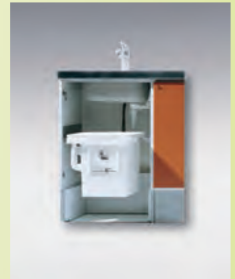
301056 Gips-Klärbecken 35-U/S für Einbau in Unterschrank mit Breite von mind. 56 cm. Verhindert ein Zusetzen der Abflüßleitungen mit Gipsschlamm. Sichtbarer Füllstand, einfache Reinigung.
